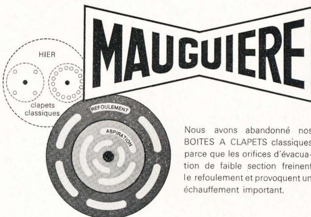
Nous avons abandonné nos BOITES A CLAPETS classiques parce que les orifices d'évacuation de faible section freinent le refoulement et provoquent un échauffement important.
